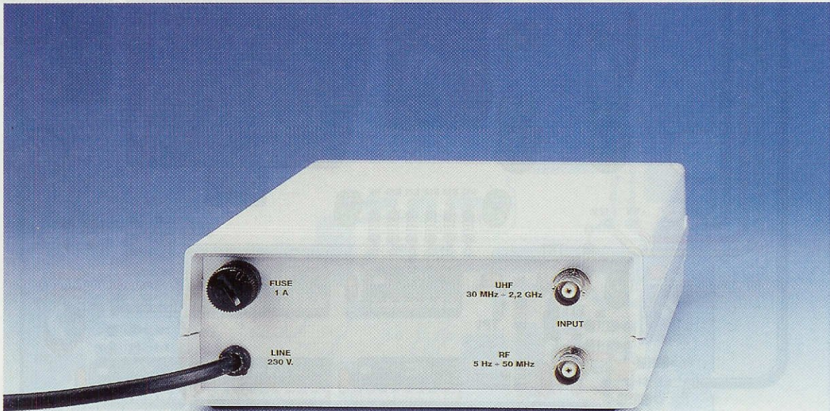
Fig.10 Nel pannello posteriore del mobile dovete fissare i due BNC per entrare con i segnali RF e UHF da misurare. In fig.11 potete vedere come questi due BNC risultano collegati al circuito stampato del frequenzimetro e al modulo SMD.
