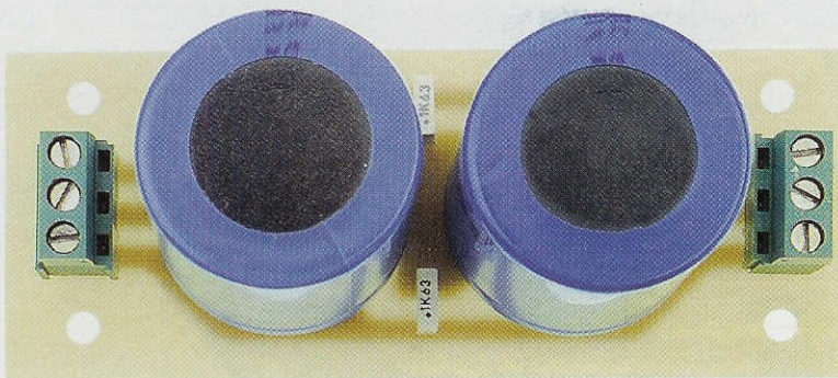
Fig.7 Foto del piccolo circuito stampato LX.1578 con sopra già montati i condensatori di fig.3.
