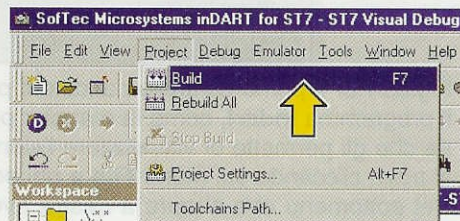
Fig.36 Generare l'eseguibile, cioè compilare il sorgente .asm , linkare l'oggetto .obj e formattare il file .cod , è facilissimo perché basta che clicchiate sul menu Project e poi sul comando Build .
